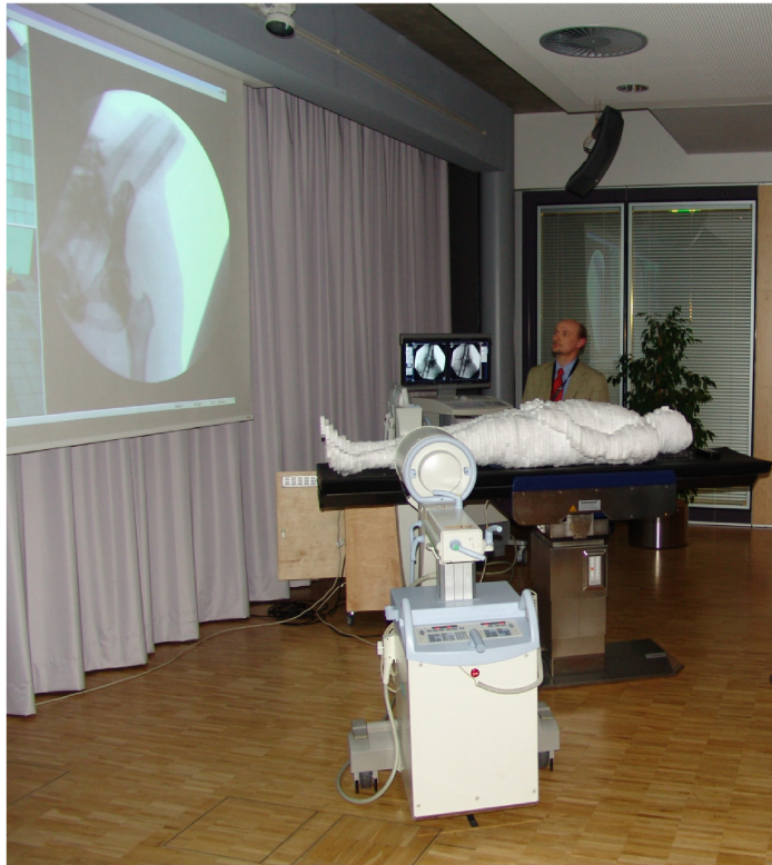
Abbildung 4: virtX gekoppelt mit realem C-Bogen und Styropor-Patienten-Dummy bei einer Präsentation
